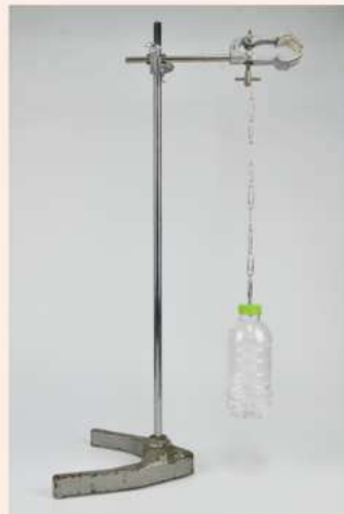
รูปการจัดอุปกรณ์สำหรับทดสอบการยืดของแบบจำลองพอลิเมอร์
