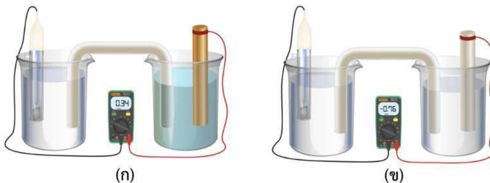
รูป 11.5 การต่อครึ่งเซลล์ไฮโดรเจนมาตรฐานกับ (ก) ครึ่งเซลล์ทองแดงมาตรฐาน (ข) ครึ่งเซลล์สังกะสีมาตรฐาน
