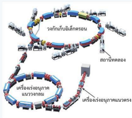
รูป เครื่องกำเนิดแสงซินโครตรอนที่สถาบันวิจัยแสงซินโครตรอน จ.นครราชสีมา
