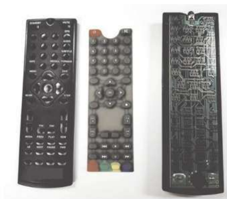
ก. ปุ่มคำสั่งต่างๆ และแผงวงจรอิเล็กทรอนิกส์
