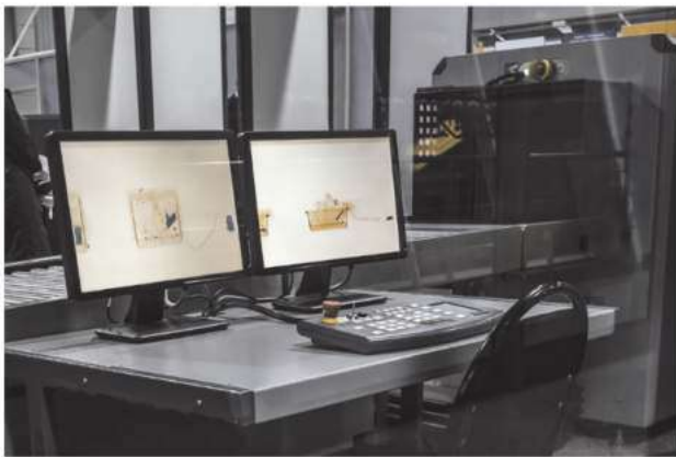
ก. การตรวจหาวัตถุอันตรายในกระเป๋าเดินทางจาก เครื่องฉายรังสีเอกซ์
