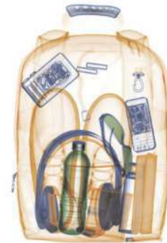
ข. ภาพแสดงสิ่งของที่ทำจากวัสดุชนิดต่าง ๆ ในกระเป๋า เมื่อผ่านการสแกนด้วยรังสีเอกซ์
