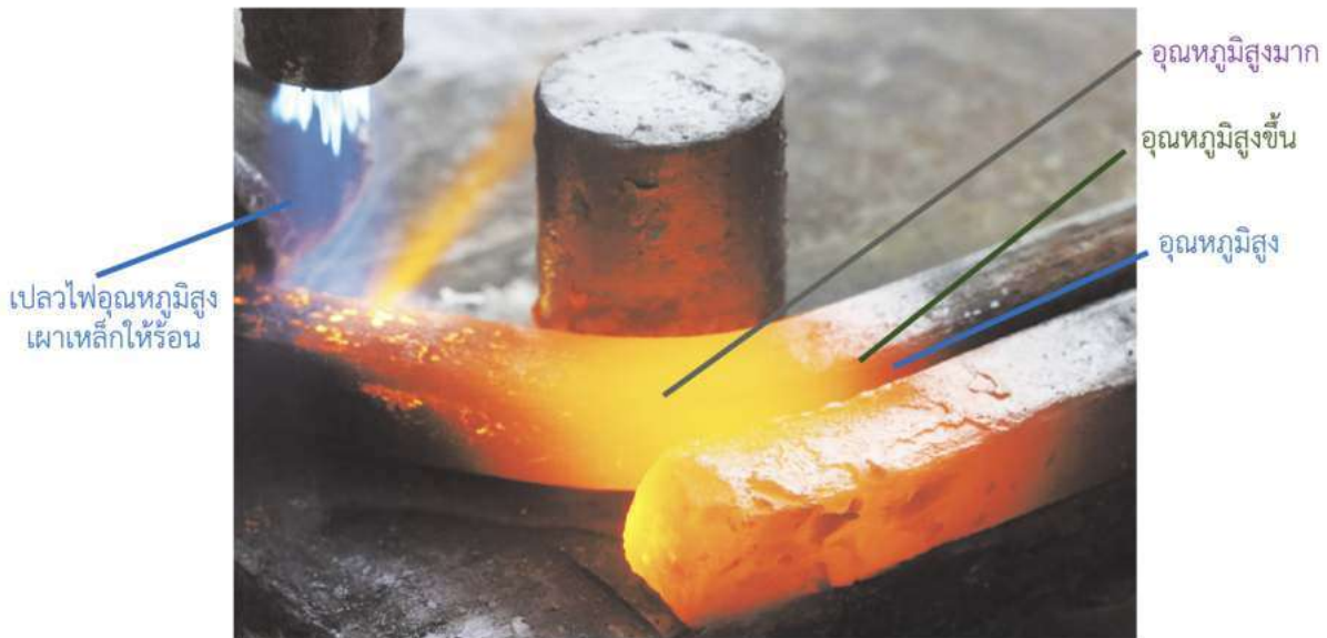
รูป 19.1 บริเวณที่เหล็กได้รับความร้อนต่างกัน จะเห็นเป็นสีต่างกัน
