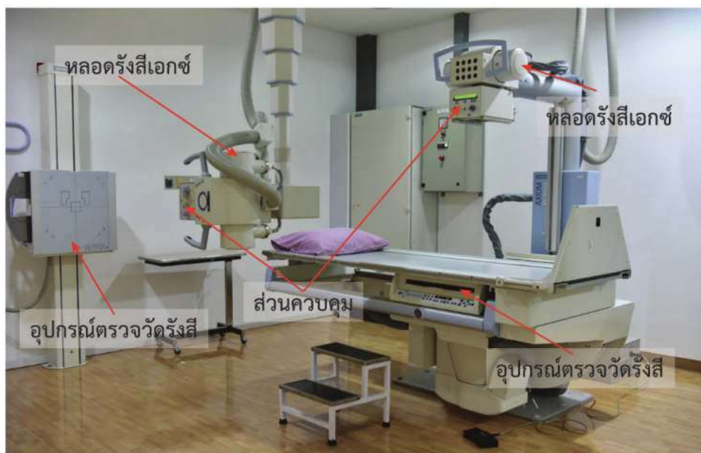
รูป 18.12 ส่วนประกอบของเครื่องฉายรังสีเอกซ์
