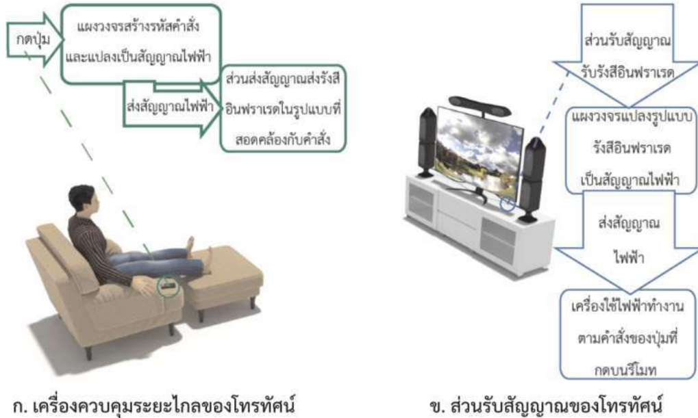
รูป 18.19 แผนภาพแสดงขั้นตอนการทำงานของเครื่องควบคุมระยะไกลและส่วนรับสัญญาณ
