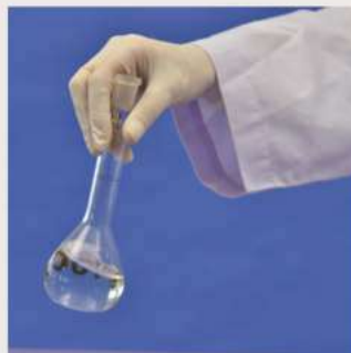
5. หมุนวนขวดกำหนดปริมาตรเพื่อให้สารละลายผสมกัน
