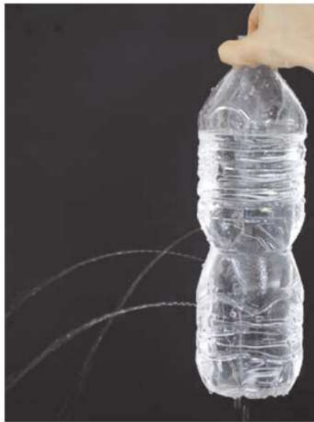
รูป 17.11 ลักษณะของน้ำที่พุ่งออกจากรูที่เจาะ ณ ตำแหน่งต่างๆบนขวดพลาสติก
