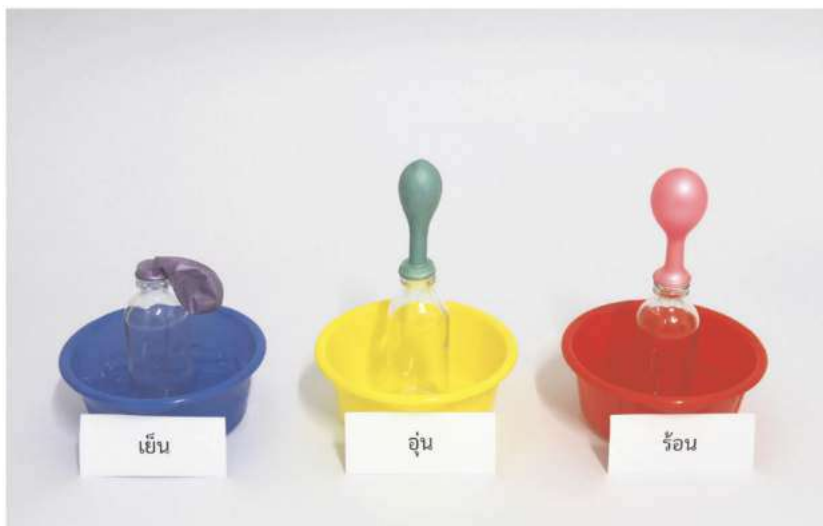
รูป 16.16 การเพิ่มความดันของแก๊สเมื่ออุณหภูมิสูงขึ้น
