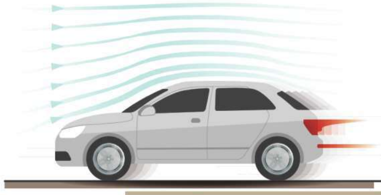
รูป 17.20 แสดงอากาศที่มีการไหลตามสายกระแสผ่านหลังรถยนต์
