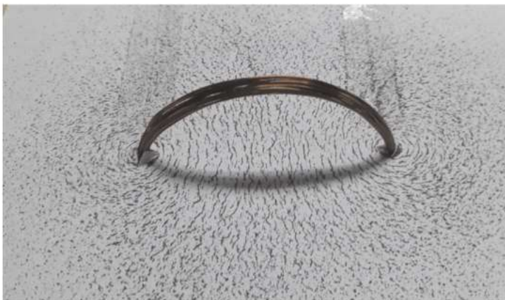
ก. การเรียงตัวของผงเหล็กรอบลวดตัวนำวงกลม
