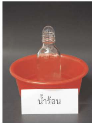
ข. แก๊สภายในขวดได้รับความร้อนทำให้ฟิล์มบางนูนขึ้นจากปากขวดแก้ว
