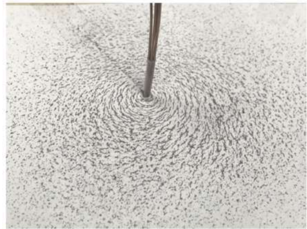
รูป 15.10 แนวการเรียงตัวของผงเหล็กรอบลวดตัวนำเส้นตรงที่มีกระแสไฟฟ้าผ่าน
