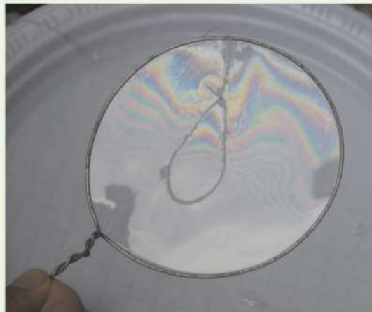
รูป การจัดอุปกรณ์เพื่อศึกษาแรงดึงผิวของของเหลว
