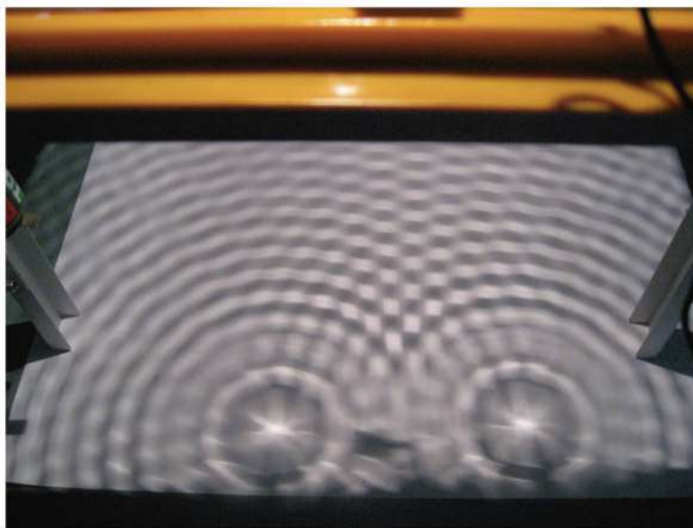
รูป 9.23 การแทรกสอดที่เกิดจากแหล่งกำเนิดอาพันธ์
