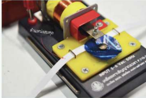
รูป ตัวอย่างการกำหนดตำแหน่งสมดุลบนแถบกระดาษ
