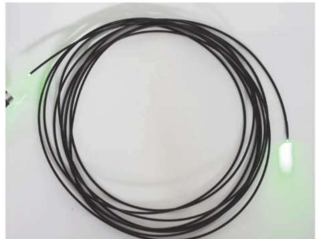
รูป 11.9 แสงที่เดินทางภายในเส้นใยนำแสง
