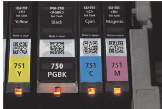
รูป 11.52 แม่สีของสารสีที่ใช้ในเครื่องพิมพ์สี ประกอบด้วย Cyan Yellow Magenta
