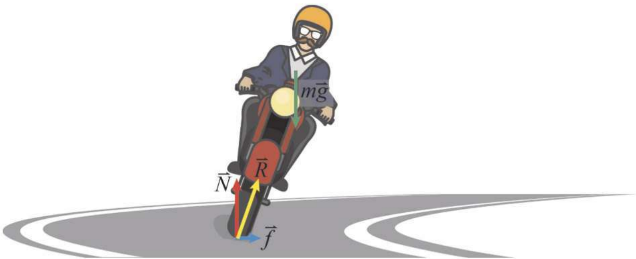
รูป 7.15 แรงที่กระทำกับรถจักรยานยนต์ขณะเข้าโค้งบนถนนในระนาบระดับ
