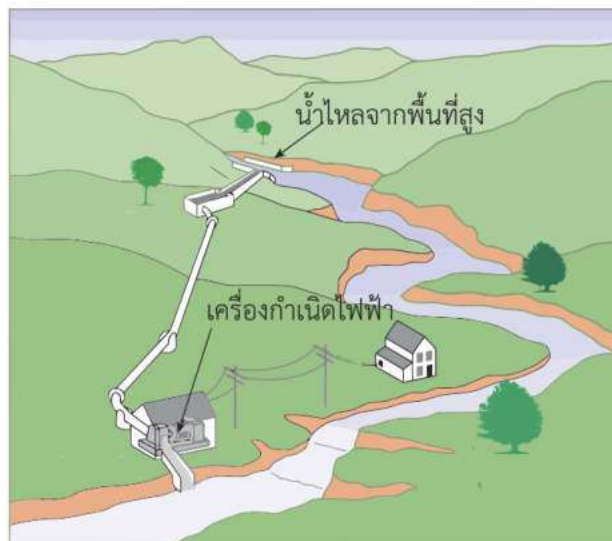
รูป 14.36 โรงไฟฟ้าพลังงานน้ำขนาดเล็ก
