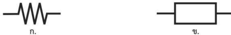
รูป 14.11 สัญลักษณ์ตัวต้านทานในวงจรไฟฟ้า
