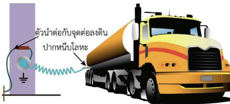
รูป 13.52 การต่อตัวนำระหว่างถังเก็บน้ำมันของรถขนส่งน้ำมันกับจุดต่อลงดิน
