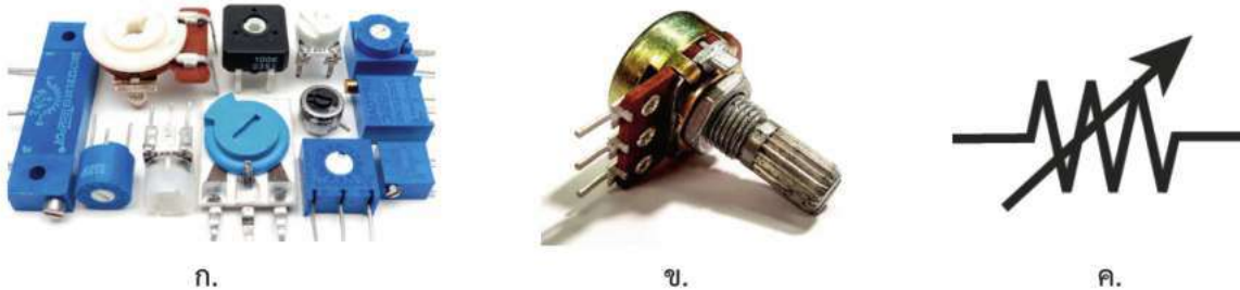
รูป 14.15 ก. ตัวต้านทานแบบปรับค่าได้ขนาดเล็ก ข. ตัวต้านทานแบบปรับค่าได้ขนาดใหญ่ ค. สัญลักษณ์ตัวต้านทานแบบปรับค่าได้ในวงจรไฟฟ้า
