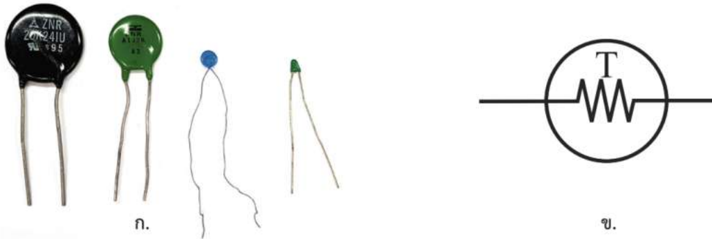
รูป 14.17 ก. ตัวอย่างตัวต้านทานที่เปลี่ยนตามอุณหภูมิ ข. สัญลักษณ์ตัวต้านทานที่เปลี่ยนตามอุณหภูมิในวงจรไฟฟ้า
