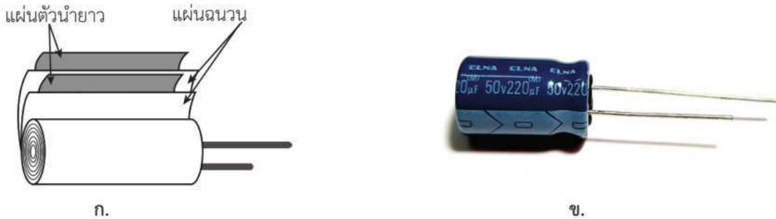
รูป 13.39 ก. โครงสร้างของตัวเก็บประจุรูปทรงกระบอก ข. ตัวเลขบอกความจุและความต่างศักย์บนตัวเก็บประจุ
