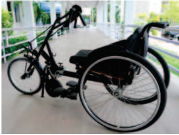
รถนั่งคนพิการแบบ 3 ล้อ (Tri wheeler) พร้อมหัวต่อมือปั่นสำหรับรถนั่งคนพิการ สามารถ เคลื่อนที่ได้ดีบนพื้นผิวขรุขระ โคลน เนินเขา และพื้นต่างระดับ
