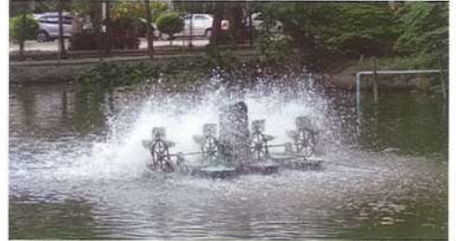
รูป 25.15 การเติมอากาศของเครื่องกังหันน้ำ
